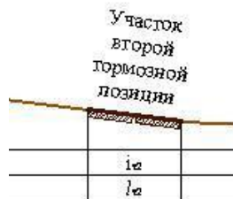
6 – Сурет – 2 – тежегіштік позицияның профилі мен жоспары
