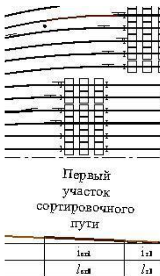
8 – Сурет – Шектік бағанадан парктік тежегіштік позицияға дейінгі сұрыптау жолдары учаскесінің профилі мен жоспары
